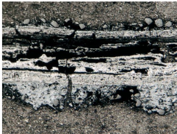
Ryc. 20. Fragment zbroi płytowej z mosiężną lamówką – mikroskopowe obrazy badanego elementu stalowego.
